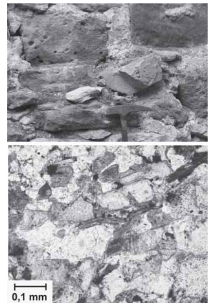
Fig. 3.- Aspecto general y fotomicrografía x 63, con niculos paralelos de la muestra Mon 6
