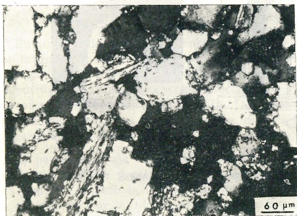
Figura 6.—Arenisca Jurásica (Malmö). Detalle de la textura donde se observan granos de cuarzo y de moscovita, y con disposición intersticial cristalitas de dolomita (N. C.).
