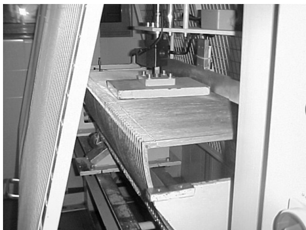
Figura 3. Banco para ensayo de flexión de peldaños de elevación.
