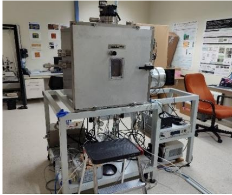
Figura 16: Cámara de sputtering del laboratorio de nanotecnología del Campus del Cristo, Universidad de Oviedo.
