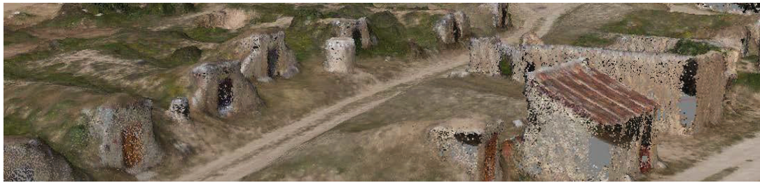
Figura 3. Nube de puntos densa (correlación imágenes UAV)
