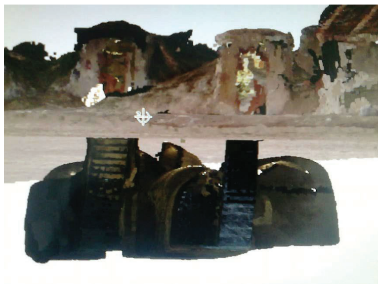
Figura 4. Acceso exterior (UAV) e interior de una bodega (MMT)
