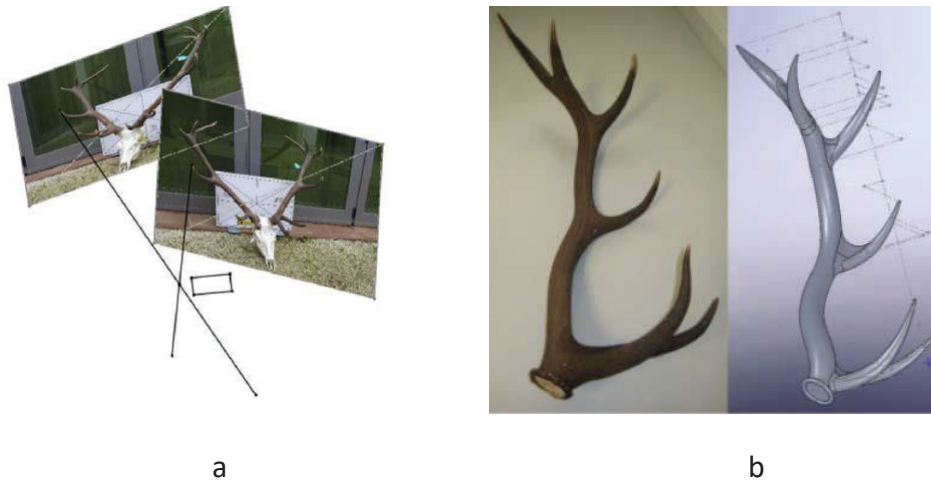
Figura 3. a) Obtención de la localización espacial de un punto mediante la intersección de rayos del punto representado en ambas fotografías. b) Modelo 3D de la cuerna del ciervo a partir de los puntos homólogos de la cuerna real.
