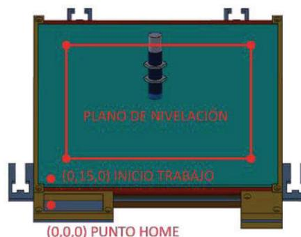
Figura 5. Detalle de nivelación de superficies de trabajo.
