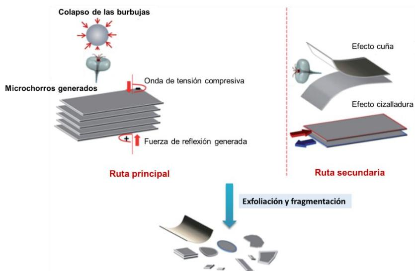
**Figura 6.** Mecanismo de exfoliación por ultrasonidos. Adaptado de [79].
