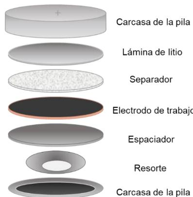
**Figura 34.** Esquema de una pila de botón.
