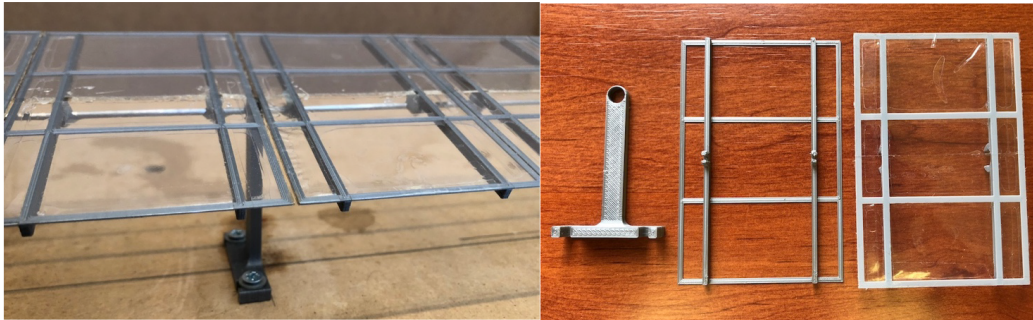
Figura 3. Modelo a escala 1/E y vista de un soporte, un marco y un panel completo.
