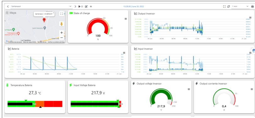
Figura 5.18. Ejemplo de visualización de datos de los equipos de Baní. Estos paneles permiten controlar de un rápido vistazo que toda la infraestructura de red, alimentación y control de accesos está disponible.
