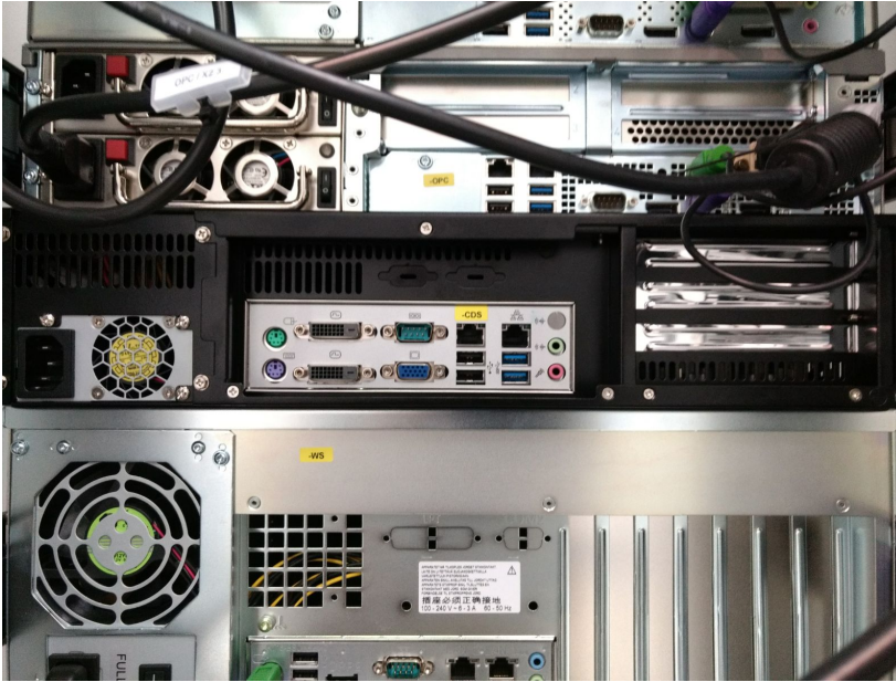
Figura 5.10. Equipo empleado como Gateway IIoT en Abdali. Se instaló en el interior de un armario de servidores o rack y debía respetar el factor de forma propio de estos equipos.
