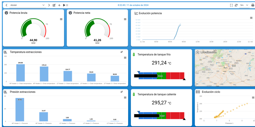
Figura 5.12. Panel de monitorización de la planta termosolar de Abdali. Resume algunos de los elementos críticos y más característicos del funcionamiento de la planta para identificar rápidamente ineficiencias en la producción.
