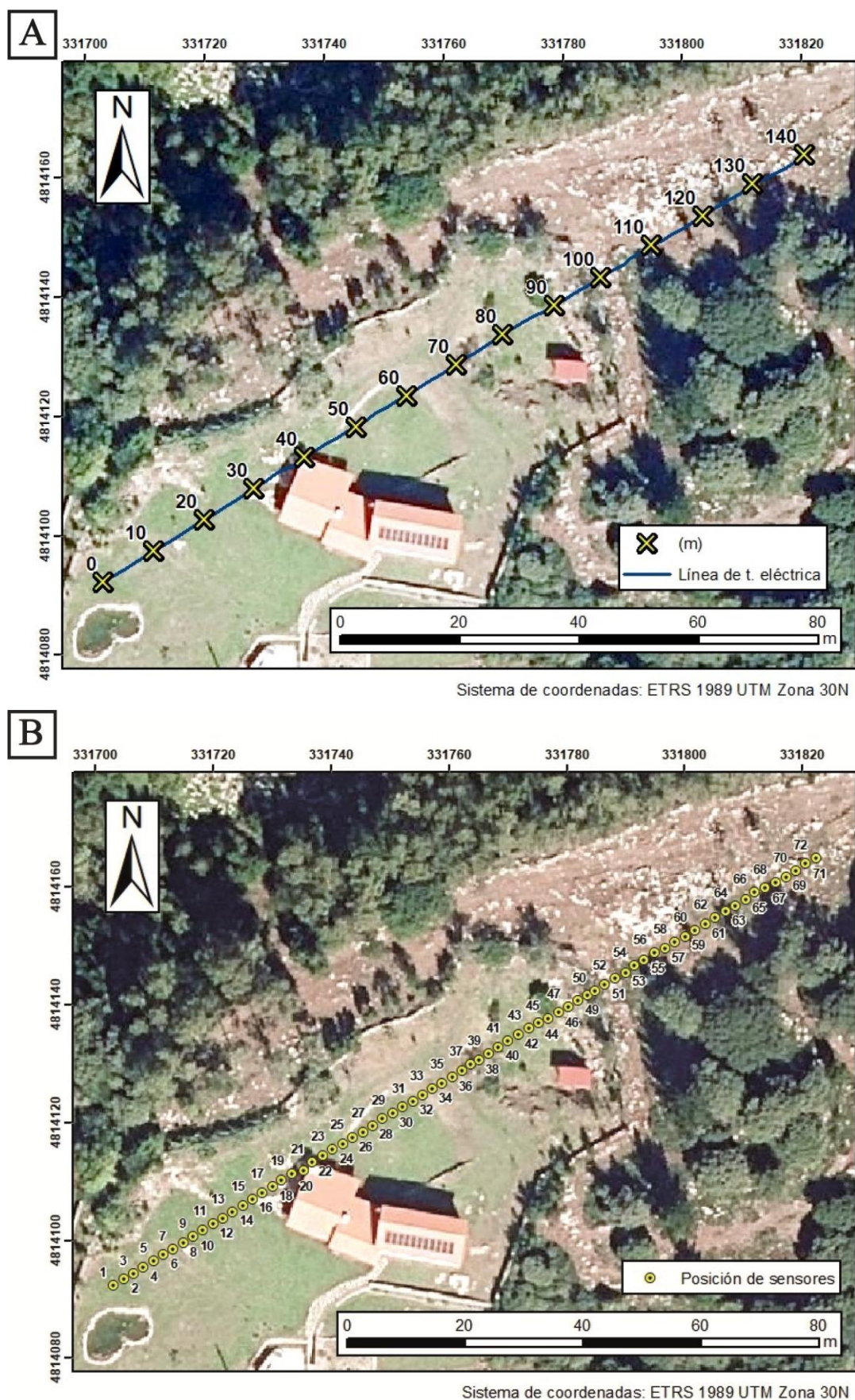
Figura 14: A) Situación de la línea del dispositivo de adquisición de datos de resistividad eléctrica con un espaciado de referencia de 10 m. B) Disposición de los sensores de medida (electrodos), de la línea del dispositivo de adquisición de datos de resistividad eléctrica.
