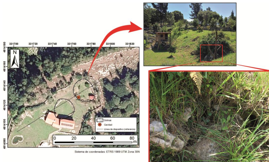
Figura 23: Mapa de situación de las dolinas y la cavidad identificadas en la superficie de la finca junto a dos imágenes a detalle de la cavidad aflorante en el margen S de la dolina N. Se trata de una cavidad de pequeño tamaño que conecta con el exterior a través de un afloramiento de roca caliza en el margen de dolina. Según atestigua el propietario de finca, se presume que esta se prolonga hacia el interior.
