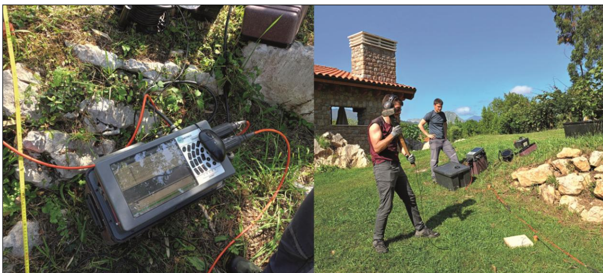
Figura 15: Izquierda: Detalle del sistema sismógrafo StrataVisor NX. Derecha: Panorámica del dispositivo sísmico antes de realizar un disparo.
