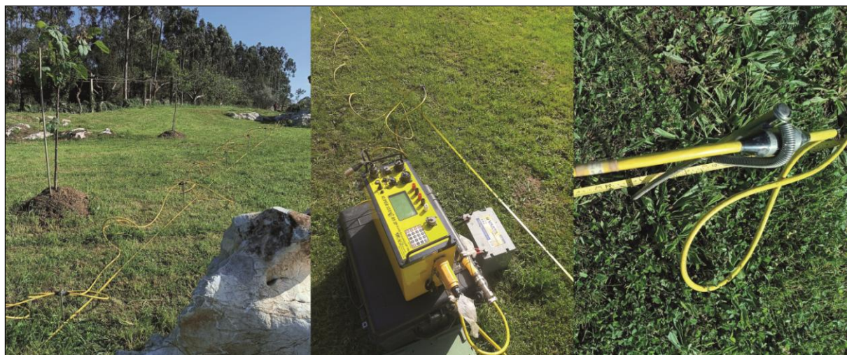
Figura 13: Izquierda: Panorámica de la línea de electrodos. Central: Resistivímetro SuperSting modelo R8/IP/SP junto a la batería de alimentación, conexiones y electrodos. Derecha: Detalle de una piqueta conectada al electrodo de transmisión mediante un muelle.
