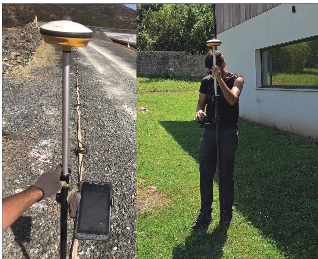
Figura 12: Izquierda: Detalle del sistema GNSS RTK E200 y la tableta con el software del GPS. Derecha: Toma de datos topográficos durante las labores de campo.
