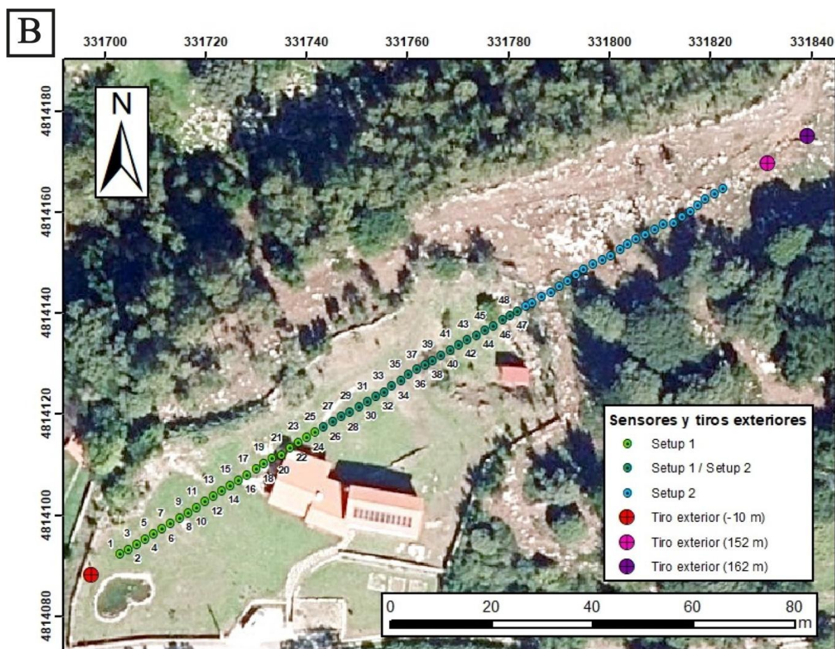
Figura 16: A) Situación de la línea del dispositivo de adquisición de datos de velocidad de propagación de ondas P mediante sísmica de refracción y la posición de los disparos correspondientes a los tiros exteriores, setup 1 y 2. B) Disposición de los sensores de medida (geófonos), de la línea del dispositivo de adquisición de datos de velocidad de ondas P mediante sísmica de refracción y posición de los disparos de los tiros exteriores.
