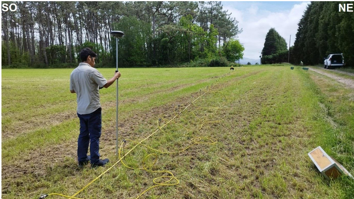
Figura 8. Medición de puntos con GPS diferencial Leica en la línea Busto-3 (vista al SE).
