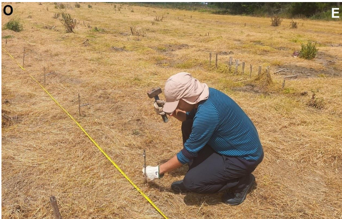
Figura 12. Instalación de electrodos cada metro y medio en la zona de estudio (vista al N).
