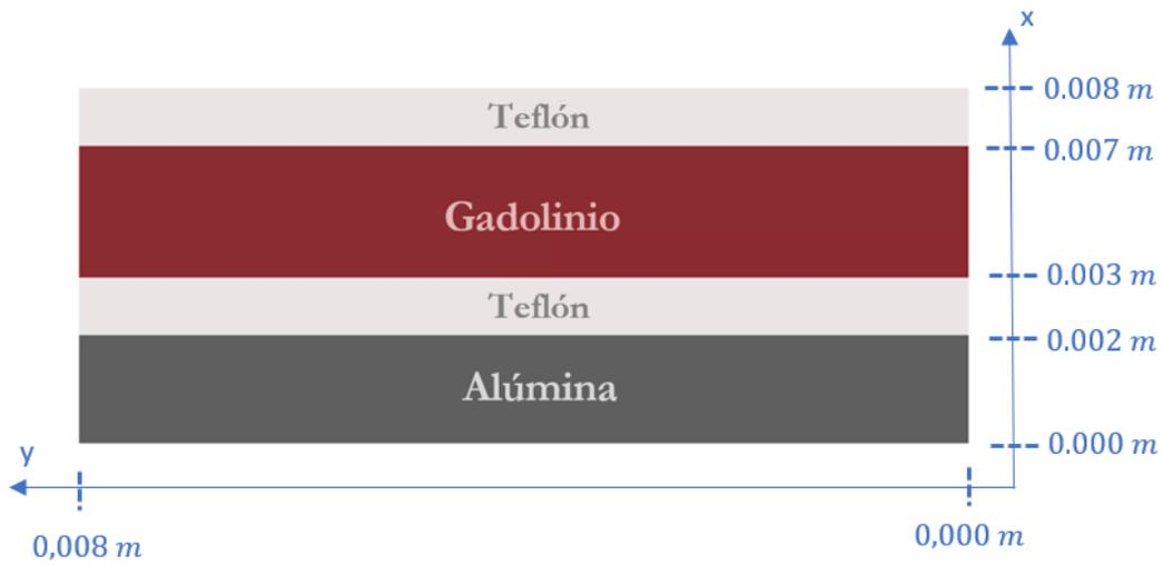
**Figura 18:** Discretización espacial de la muestra en 2D.
