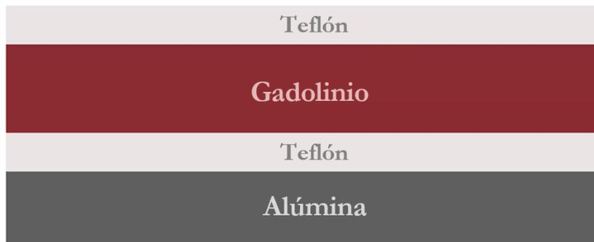
**Figura 7:** Esquema representando las capas de distintos materiales que conforman el del sistema.
