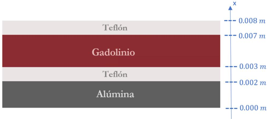
**Figura 17:** Discretización espacial de la muestra en 1D.
