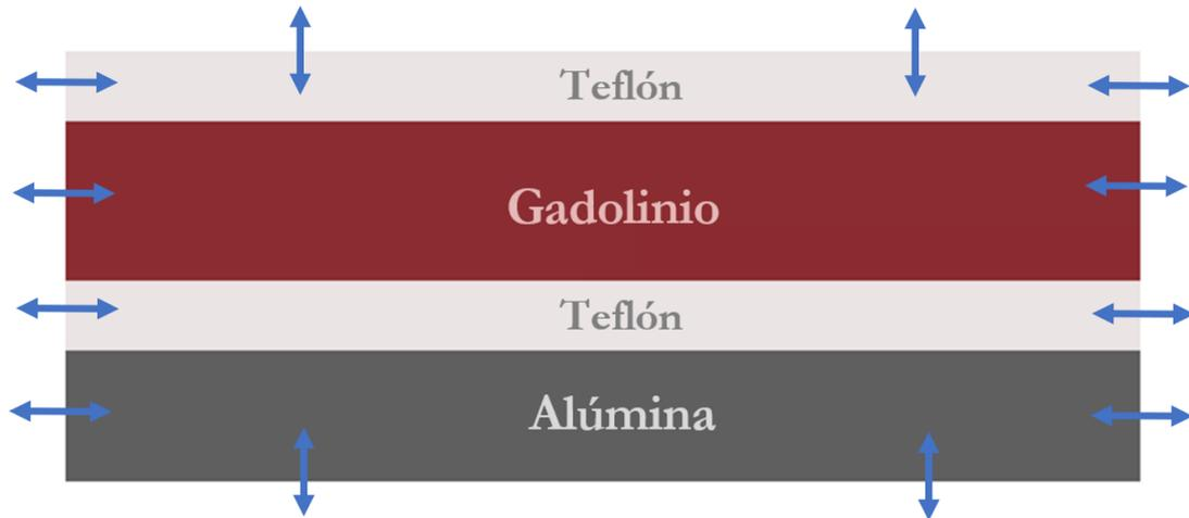
**Figura 9:** Convección en la muestra.
