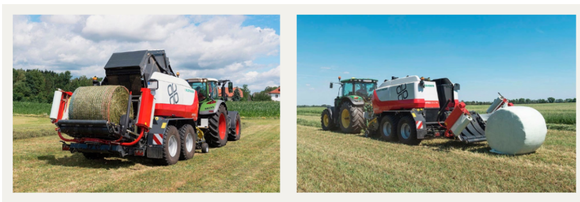
Ilustración 20. Empacadora de hierba para su curación, en concreto esta máquina hace bolas y más tarde las encinta. Estas imágenes han sido obtenidas del catálogo de productos de la marca Krone.
