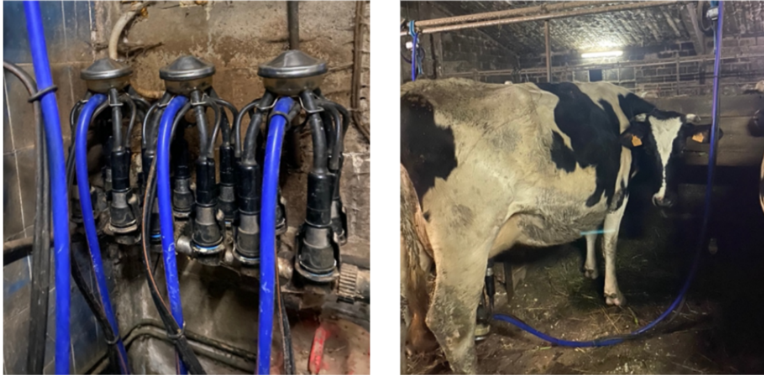
Ilustración 4. Máquina de ordeño directo, formada por la ordeñadora y su disposición en una vaca.
