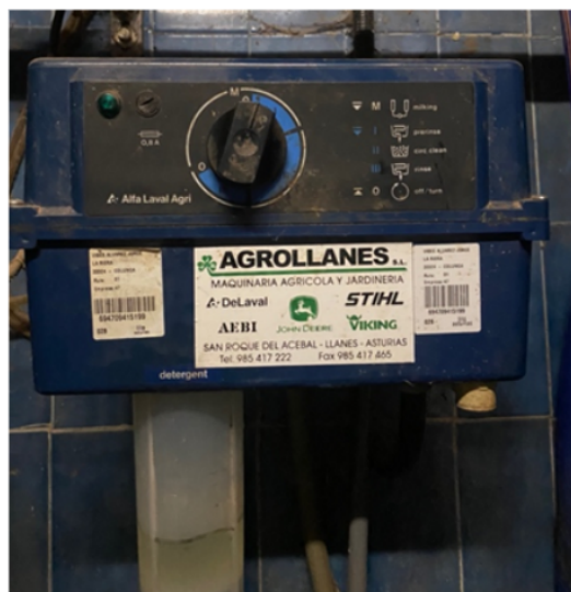
Ilustración 5. Sistema de lavado automático incluido en el ordeño directo.
