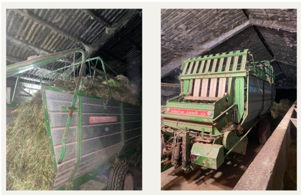
Ilustración 2. Autocargador conectado al tractor que permite recoger la hierba recién segada de forma automatizada.
