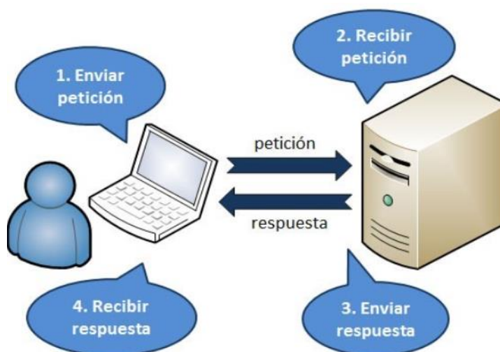
Figura 6.1.- Esquema del modelo petición-respuesta
