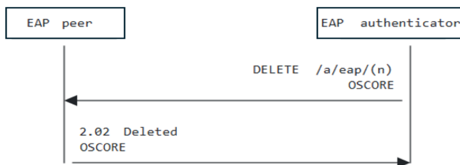
Figura 6.37.- MSC de la eliminación de un cliente del dominio de autenticación
