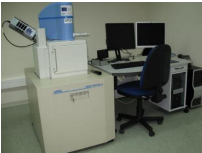
Fig. 12. Equipo JEOL 6610LV empleado para la obtención de imágenes SEM y datos de EDX.
