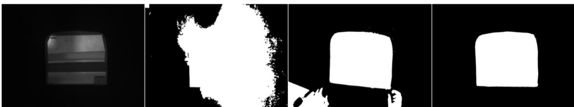
Fig. 63. Otro ejemplo en el que una elección mala, manual (segunda imagen) o automáticamente (Otsu, tercera imagen), del umbral afecta a la segmentación de la pieza (bien segmentada con un umbral preciso a la dcha.).
