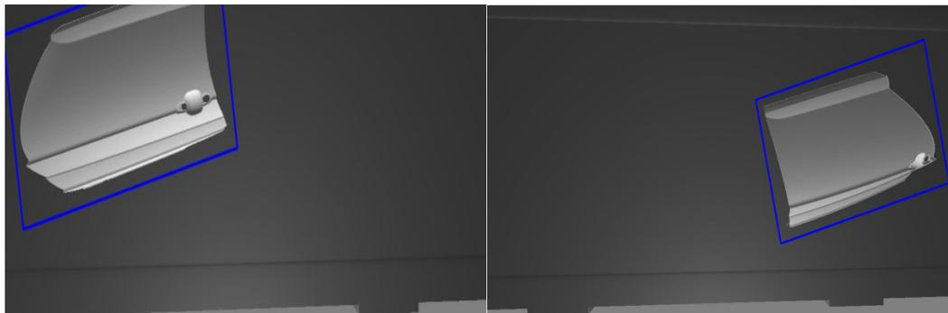
**Fig. 119.** Pieza en distintas posiciones y perspectivas son su cuadro delimitador orientado estimado.
