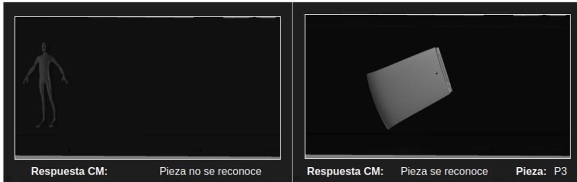
Fig. 83. Ejemplo de un objeto no reconocido y una pieza sí identificada por el sistema. En este caso se trata de un objeto extraño, pero tampoco reconocería una pieza que, aunque de forma conocida, tuviera una pose incorrecta.
