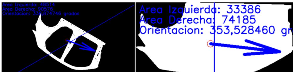
Fig. 69. Ejemplos del uso del producto vectorial para determinar el sentido de orientación natural de un objeto. La discordancia en la primera imagen se debe, además de al ruido, a que la flecha se estimó en base al área de la pieza rellena y la línea media con el área útil de la pieza.
