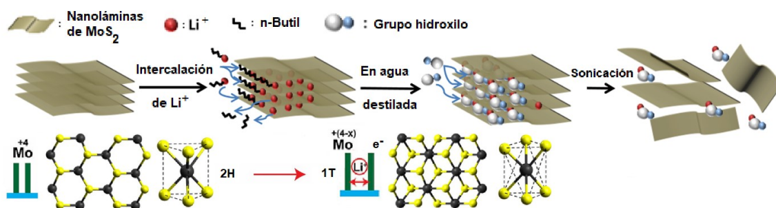
Figura 11. Esquema del mecanismo de la exfoliación asistida por intercalación química de Li + . Adaptado de [85] y [86].
