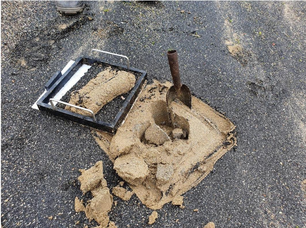
**Figura 4.1** Fotografía del muestreador utilizado en las distintas campañas de muestreo y ejemplo de toma de muestra sobre mancha de carbón.
