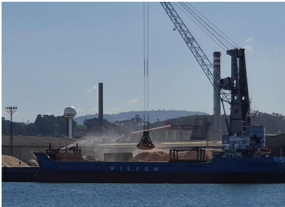
**Figura 7.14** Fotografías del muelle Raíces tomadas desde la playa de San Balandrán. En la imagen se muestran las operaciones de descarga de graneles sólidos. Se pueden apreciar los aspersores que se emplean para regar las pilas de diversos materiales, evitando que se levanten polvaredas.
