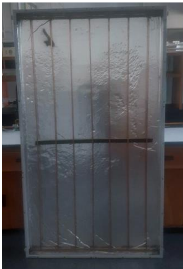
Figura 23. Módulo de colector solar para sistema de producción energía térmica.
