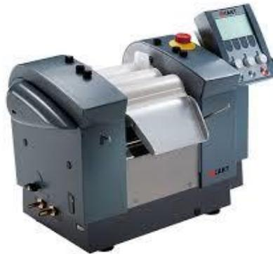
Figura 6.35. Calandra de alta cizalla como la empleada en la obtención de los materiales aquí analizados.
