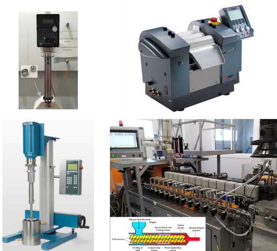
Figura 6.2. (Izquierda-Arriba) Mezclador Silverson de alta cizalladura. (Izquierda-Abajo) Equipo piloto de mezclador toroidal Dispermat. (Derecha-Arriba) Calandra de alta cizalla. (Derecha-Abajo) Mezclador de termoplásticos basado en tornillo sin fin doble.
