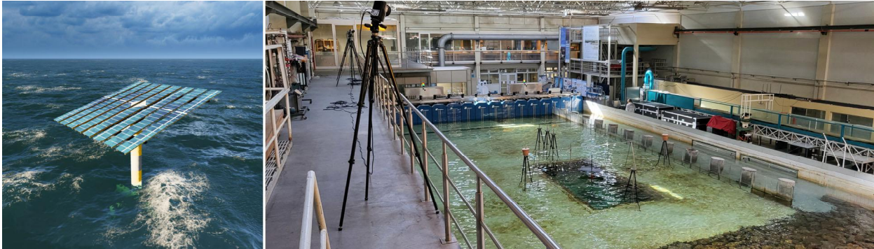
Figura 9. Concepto de Helioseas (panel izquierdo) y ensayos físicos realizados sobre el modelo a escala 1:30 (Claus et al., 2024).
