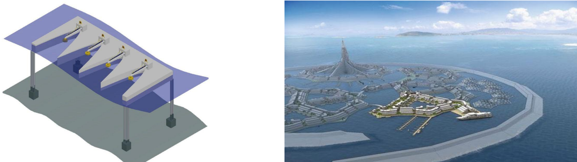
Figura 6. Nuevas aplicaciones de los diques flotantes. El panel izquierdo muestra un concepto de dique flotante parabólico con convertidores de energía del oleaje (Zhang and Ning, 2019b) y el panel derecho un diseño conceptual de un aeropuerto flotante (Zhang et al., 2020).
