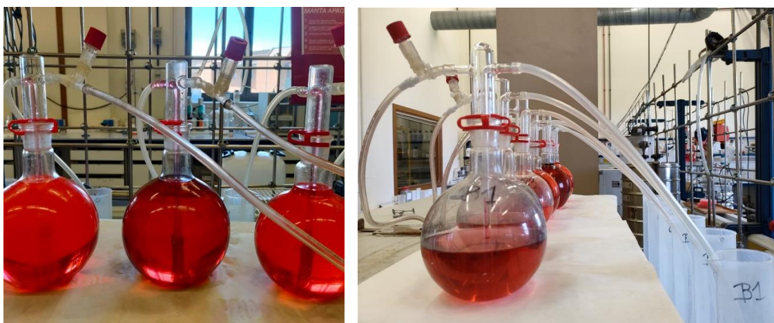
Figura 24. Sistema de desplazamiento para medir el volumen de biogás generado
