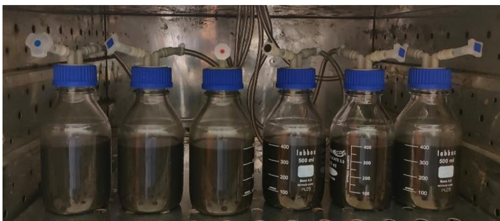
Figura 23. Botellas llenas con inóculo tamizado utilizadas en el ensayo de biodegradabilidad
