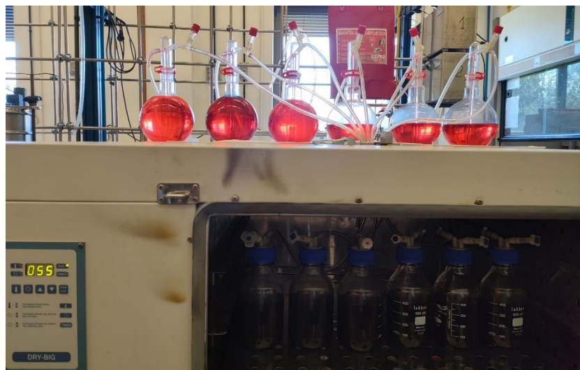
Figura 22. Montaje experimental para el ensayo de biodegradabilidad
