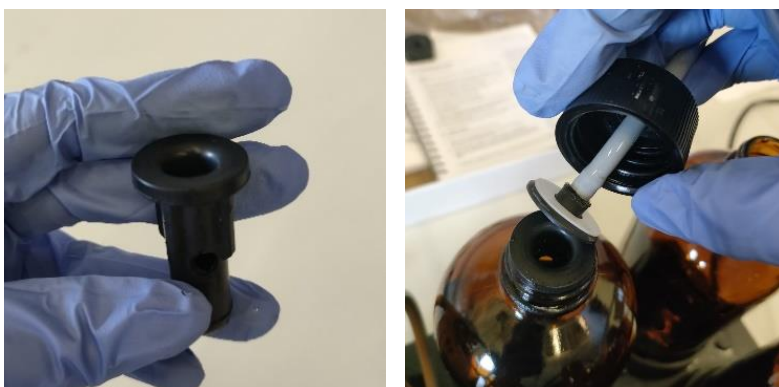
Figura 17. Copa de silicona para introducir las pastillas de hidróxido potásico y cierre del tapón hermético
