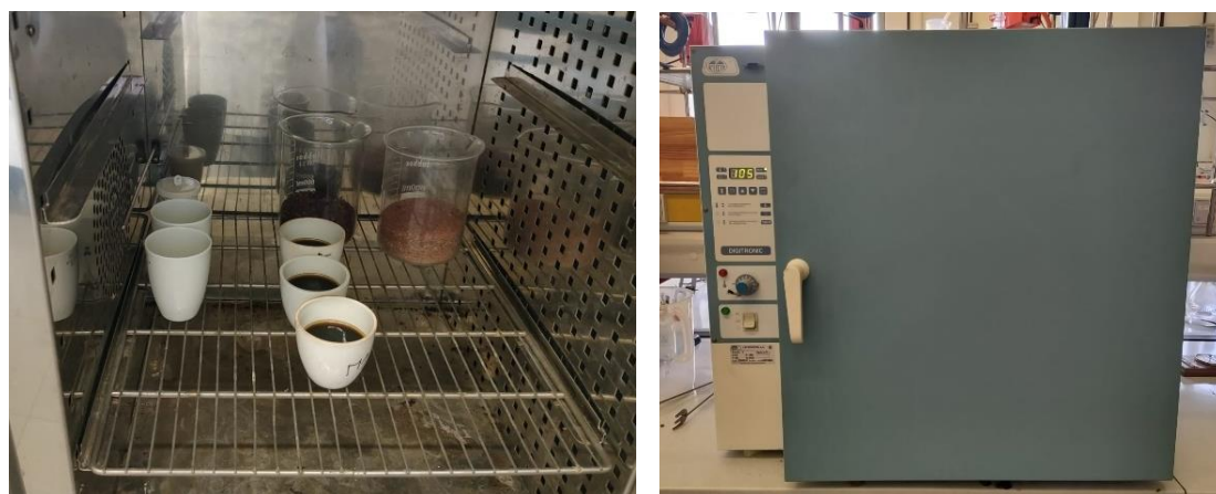
Figura 13. Estufa con crisoles para la determinación de sólidos totales
