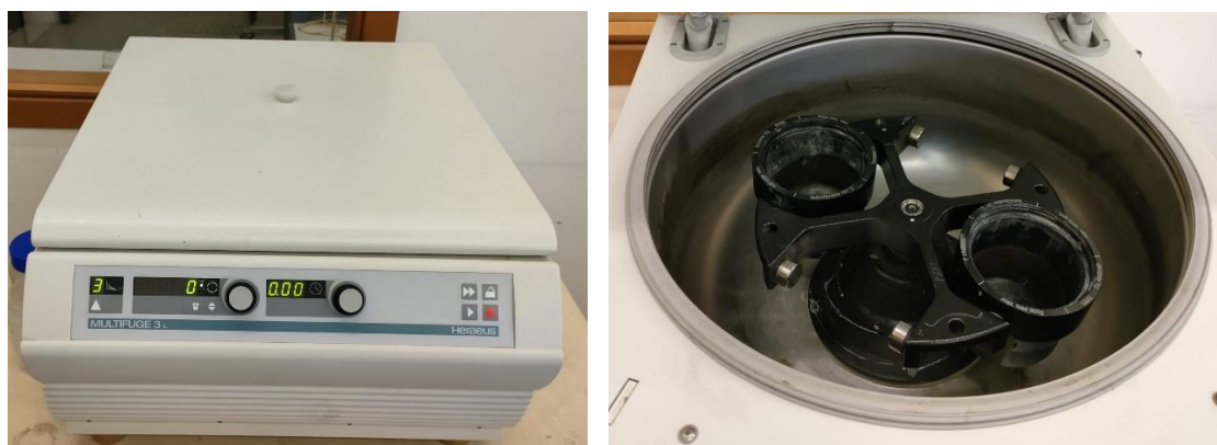
Figura 19. Máquina centrífuga modelo Multifuge 3L
