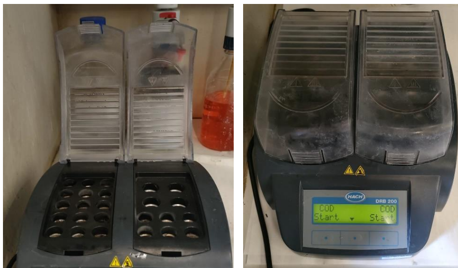
Figura 11. Bloque calefactor HACH DRB200 para el análisis de la DQO
