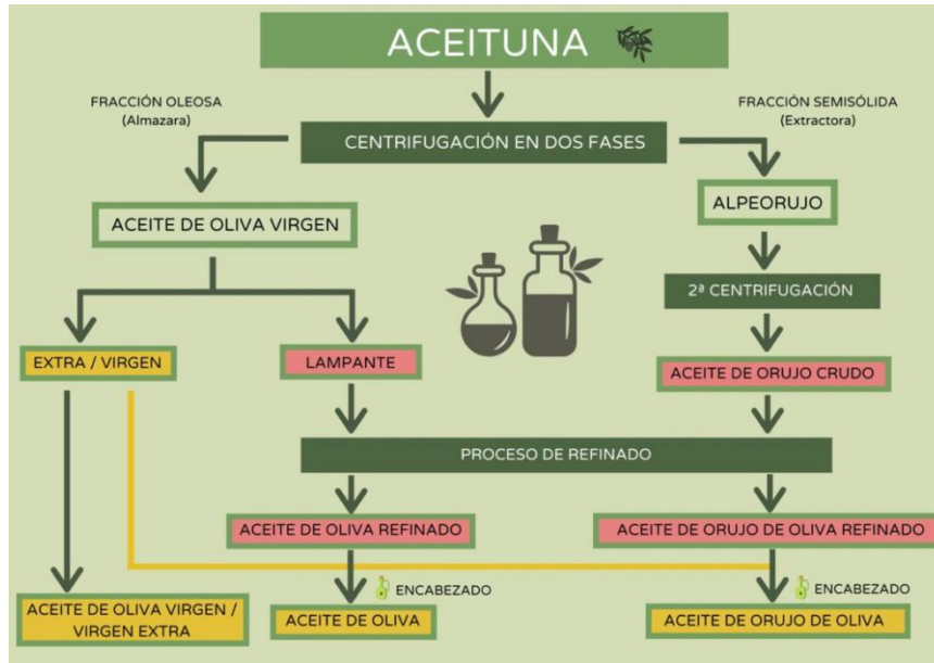
Figura 7: Resumen obtención aceites de oliva
