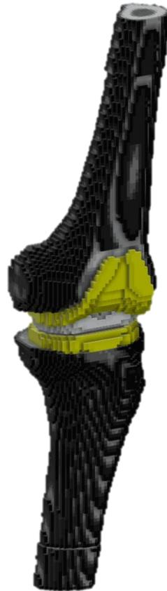
Figura 3.8.- Articulación de la rodilla con la prótesis ya implantada y voxelizada.
