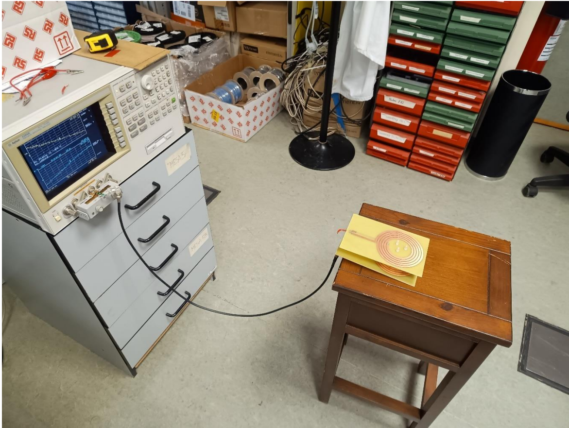
Figura 4.13.- Montaje para las mediciones de las espiras y su acoplamiento
