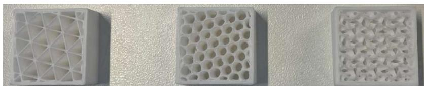
Figura 4.23. Resultados, tras post-procesamiento, del proceso de optimización del tipo de patrón de relleno (Elaboración propia).
