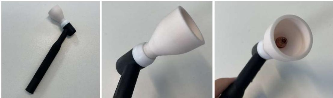
Figura 5.2. Montaje de la boquilla en la pistola del equipo TIG (Elaboración propia).
