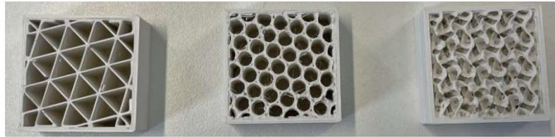
Figura 4.22. Resultados, tras impresión, del proceso de optimización del tipo de patrón de relleno (Elaboración propia).
