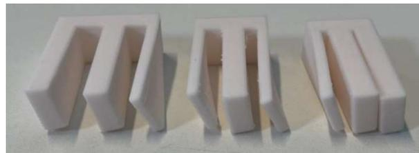
Figura 4.44. Artefactos para la resolución de ranuras fabricados en alúmina (Elaboración propia).
