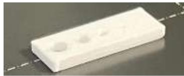
Figura 4.35. Artefacto para la resolución de agujeros fabricado en PLA (Elaboración propia).
