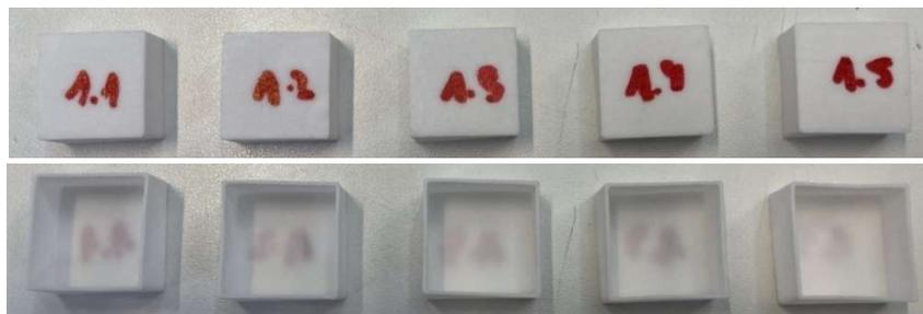
Figura 4.16. Resultados, tras post-procesamiento, del proceso de optimización del número de capas inferiores (Elaboración propia).
