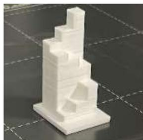
Figura 4.33. Artefacto para el eje Z fabricado en PLA (Elaboración propia).
