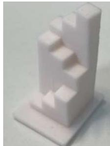
Figura 4.40. Artefacto para el eje Z fabricado en alúmina (Elaboración propia).
