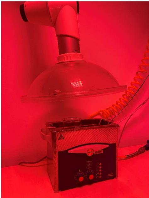
Figura 3.7. Sistema empleado para la realización del tratamiento de desbanderizado químico (Elaboración propia).
