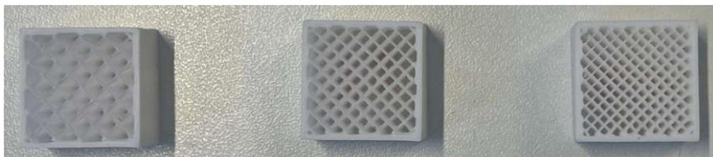
Figura 4.21. Resultados, tras post-procesamiento, del proceso de optimización del porcentaje de relleno (Elaboración propia).
