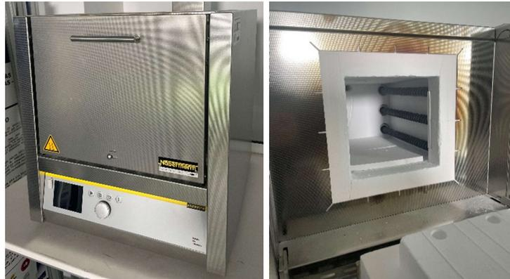
Figura 3.8. Horno Nabertherm para post-procesos térmicos (Elaboración propia).
