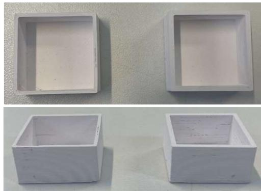
Figura 4.17. Resultados, tras impresión, del proceso de optimización del número de perímetros (Elaboración propia).
