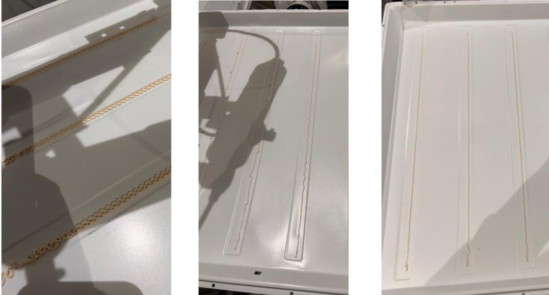
Figura 7.2: Fenómeno de *rizado* en los hilos de adhesivo
