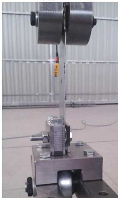
Figura 3.9. Fotografía de los ensayos de tracción de las probetas de chapas soldadas
