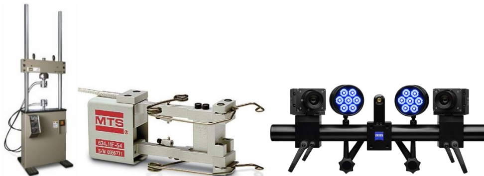
Figura 3.2. (Izquierda) Máquina universal de ensayos MTS 810, (Centro) Extensómetro axial MTS de 25 mm de longitud del calibre, (Derecha) Sistema de medición ARAMIS
