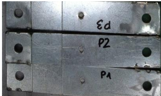
Figura 3.8. Probetas formadas por dos chapas unidas por un punto de soldadura elaboradas
