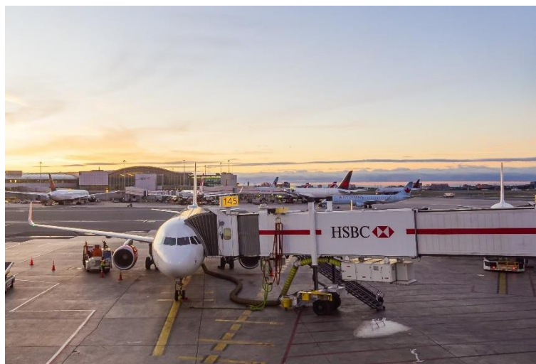
Figura 2.4. Pasarela de embarque de pasajeros de TK Elevator con suelo, techo y paredes de chapa delgada plegada en Toronto Pearson Airport
