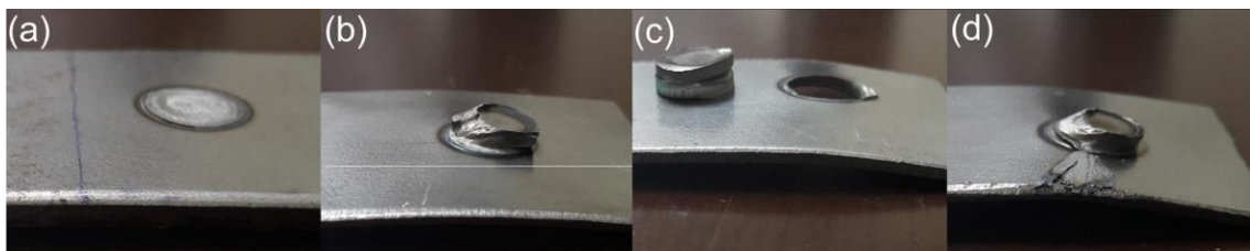
Figura 2.12. (a) Modo de fallo interfacial, (b) Modo de fallo interfacial parcial (c) Modo de fallo de extracción del botón (d) Modo de fallo de espesor parcial y de extracción del botón parcial [26]
