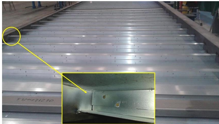
Figura 2.3. Paneles de chapa delgada plegada unidos por puntos de soldadura empleados en suelo, techo y paredes de pasarelas de embarque de pasajeros
