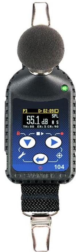
Figura 20. Dosímetro («Dosímetro de Ruido - SV 104 - SVANTEK - Sound and Vibration», 2023.)
