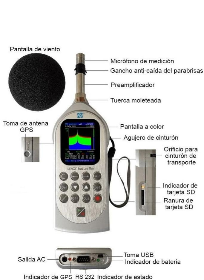
Figura 19. Partes de un sonómetro («Sonómetro de Campo Clase 1 AWA6228 Plus - Zamsu Corporación», 2024).
