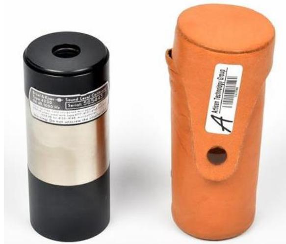
Figura 46. Calibrador Brül y Kjær Norsonic 423046. («Bruel & Kjaer (Sound Level Calibrator) 4230 | ArtisanTGTM» 2023).
