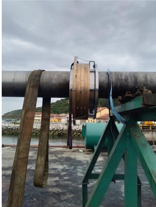
**Ilustración 35: Colocación del sello de popa con las juntas en el eje propulsor**
