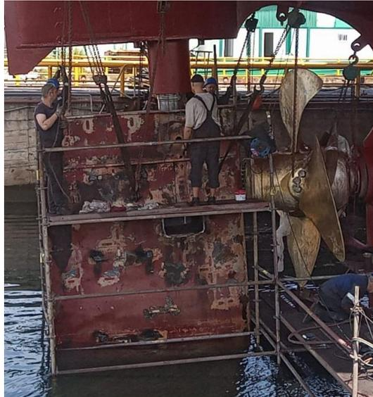
**Ilustración 44: configuración de polipastos para la inserción de la pala del timón**
