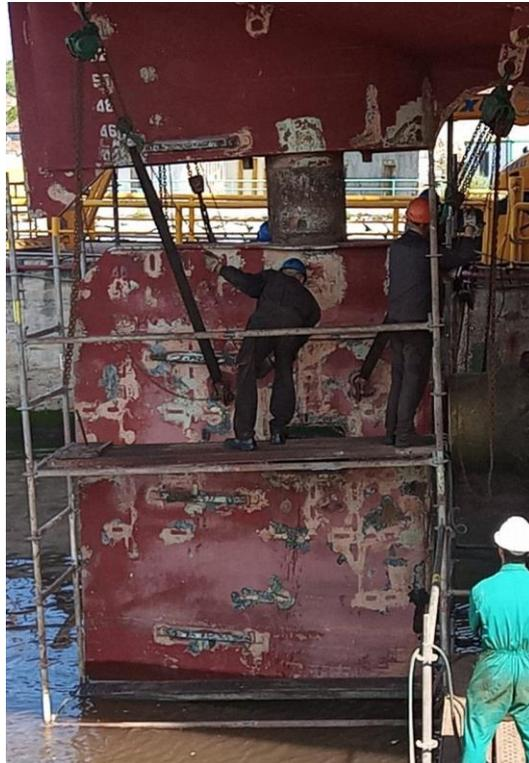
**Ilustración 14: Posición de los polipastos sujetando la pala del timón**
