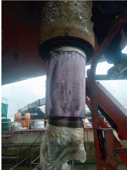
**Ilustración 30: Aplicación del líquido revelador y resultado final**
