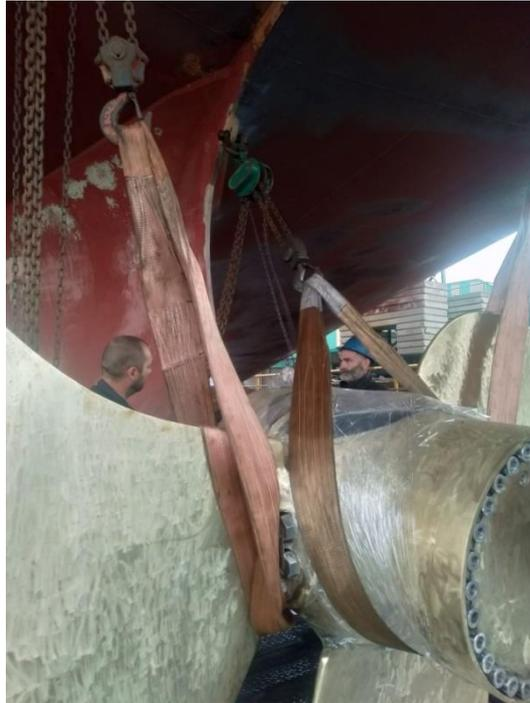
**Ilustración 26: primeros pasos de la extracción del eje**
