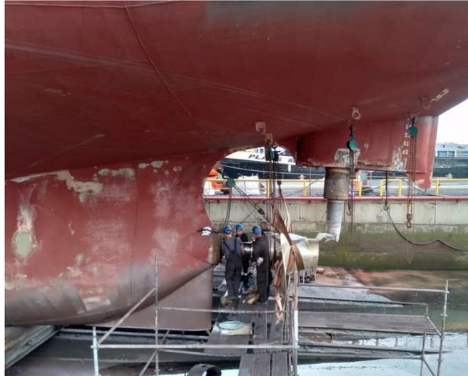
**Ilustración 38: Último tramo de la inserción del eje propulsor**
