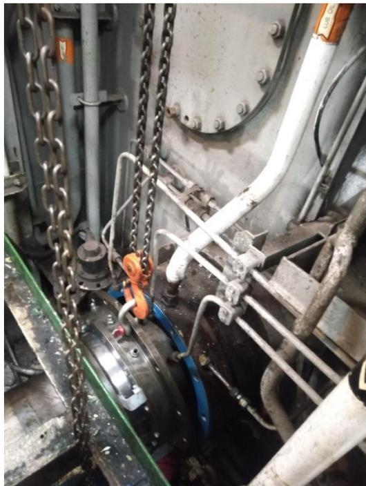
**Ilustración 36: Sello de proa de la bocina del eje propulsor suspendido**
