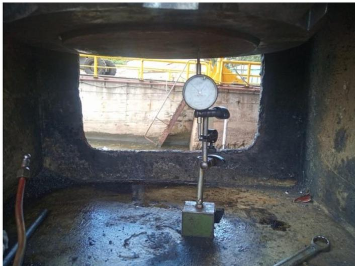
**Ilustración 48: Colocación del reloj comparador entre el mamparo de la pala y la mecha del timón**
