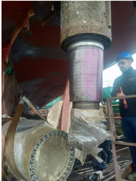
**Ilustración 29: Aplicación del líquido penetrante en la mecha del timón**
