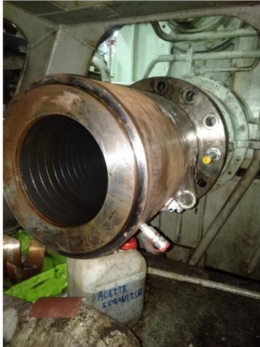
**Ilustración 25: Imagen del mangón del acoplamiento donde se aprecian las ranuras de reparto del aceite y la conexión del aceite de dilatación**
