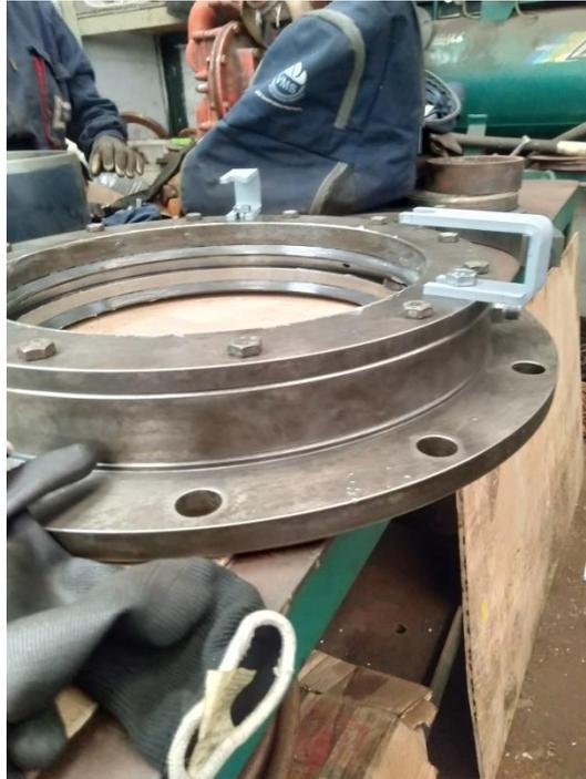
**Ilustración 34: soporte del sello de proa de la bocina del eje propulsor**
