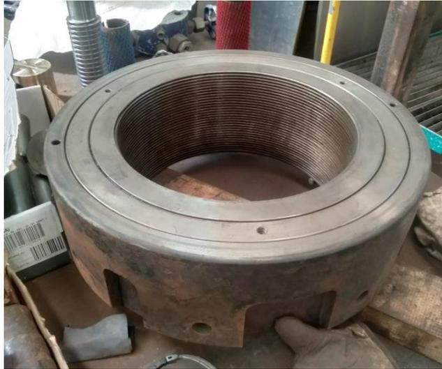
**Ilustración 42: Tuerca gato del timón después de la limpieza**
