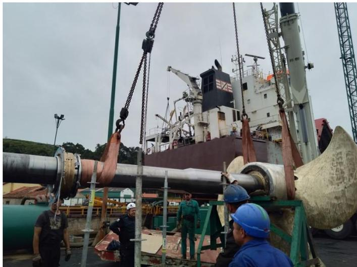
**Ilustración 28: colocación del eje propulsor en el muelle**
