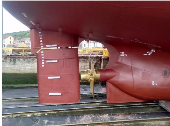
**Ilustración 50: Hélice y pala del timón finalizadas**
