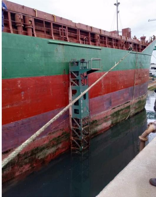
**Ilustración 10: Cabo de retención en una varada**
