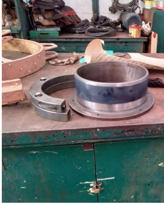
**Ilustración 33: Casquillo del sello de proa de la bocina del eje propulsor junto con las dos medias lunas del zuncho**
