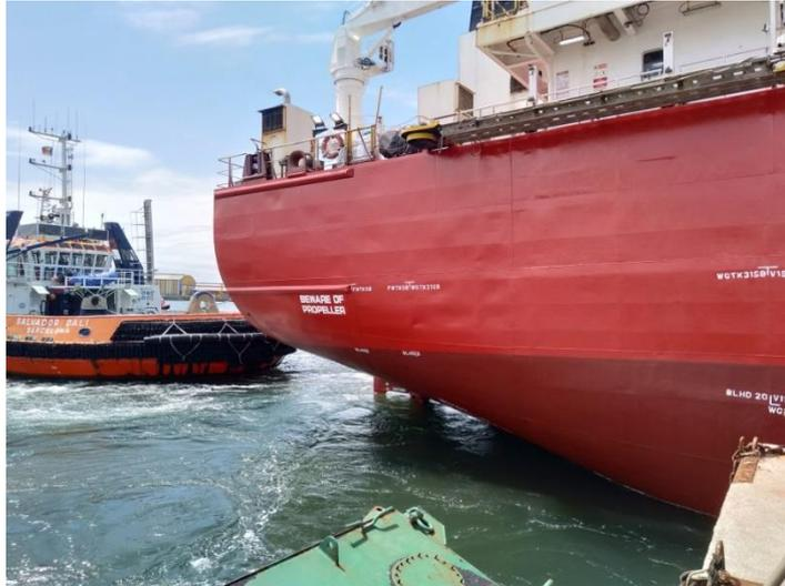
**Ilustración 52: Maniobra de remolcaje del buque desde el final de la grada**
