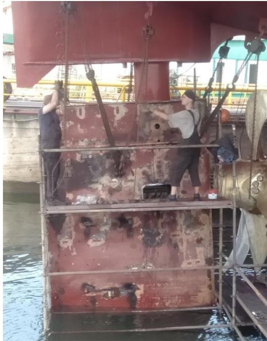
**Ilustración 16: Colocación de los 6 polipastos para la extracción de la pala**
