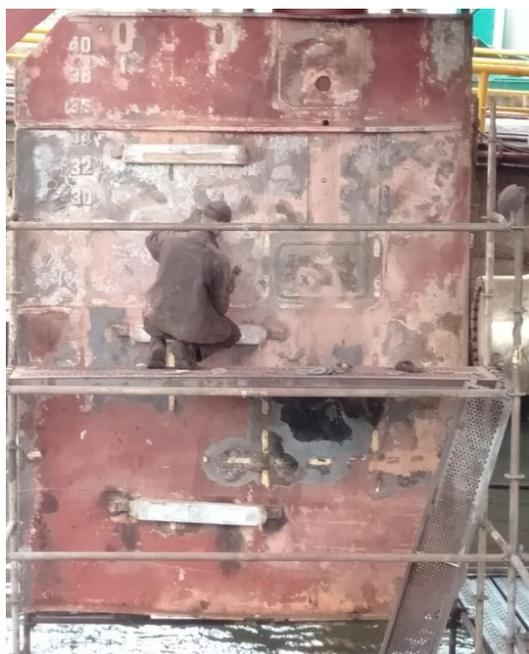
**Ilustración 49: Cesáreas cerradas y limpieza mecánica de la pala del timón**
