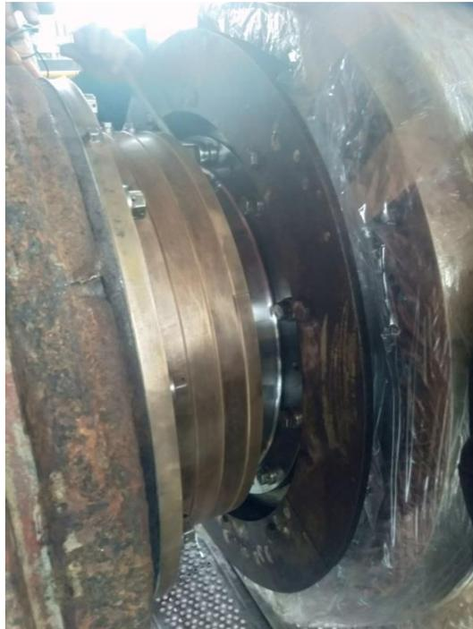
**Ilustración 39: fijación de los sellos exteriores**
