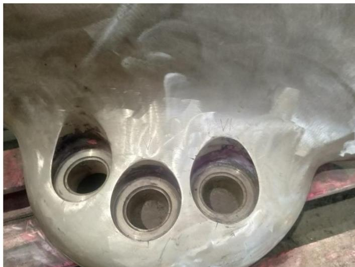
**Ilustración 21: Base de la pala de la hélice con la numeración y la marca del apriete**
