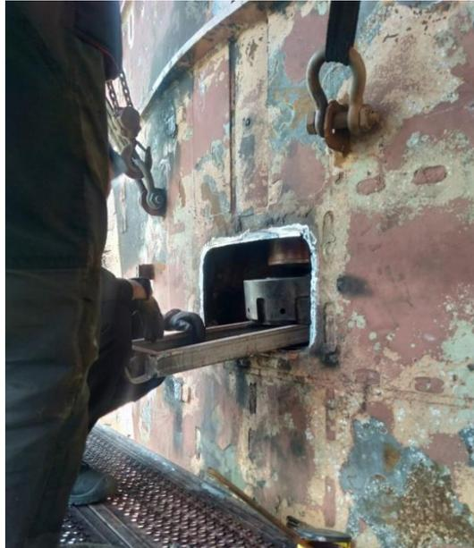
**Ilustración 45: colocación de la tuerca gato en la mecha del timón**
