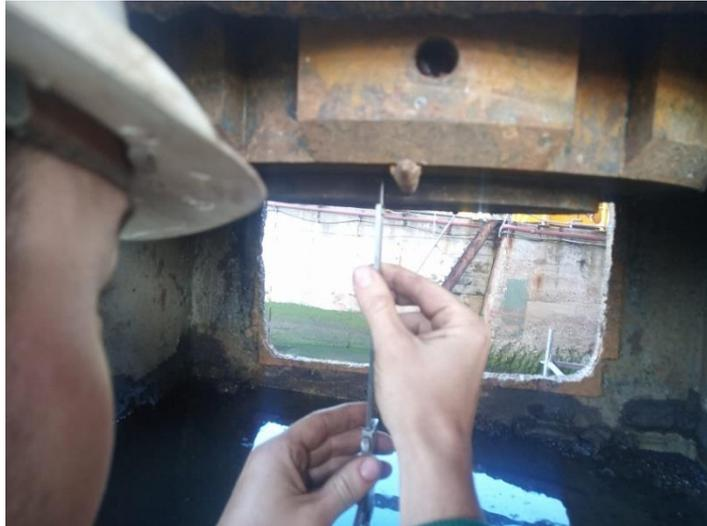
**Ilustración 13: Medición de posición del timón**
