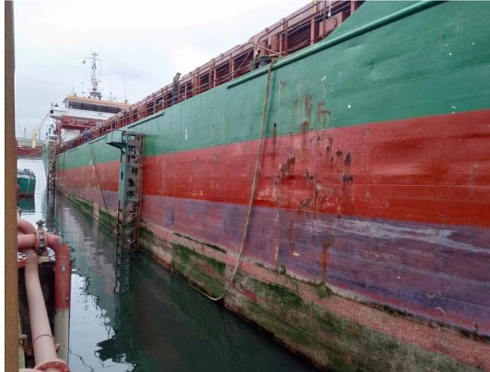
**Ilustración 11: Cabos de subida entre carro y un buque en la torreta de proa**
