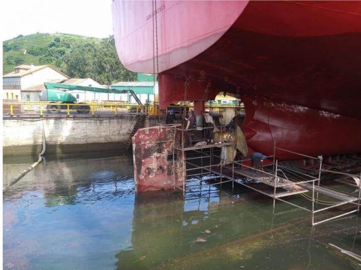
**Ilustración 17: Extracción de la pala con el camión grúa**
