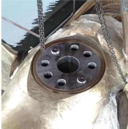
**Ilustración 20: conexión entre la pala y el núcleo de la hélice**
