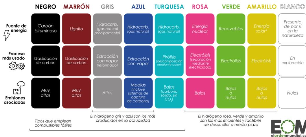
Figura 2. Clasificación de los principales tipos de hidrógeno en función de su fuente de energía, proceso de obtención y emisiones asociadas [3].
