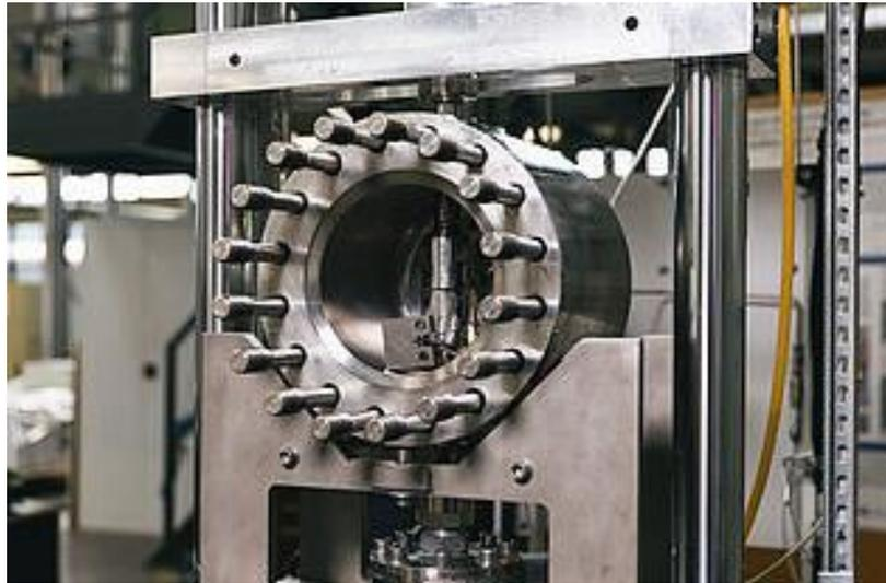
Figura 9. Dispositivo empleado para el estudio del hidrógeno mediante gas a presión [34].
