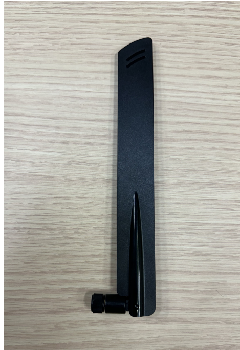
Figura 3.11: Antena de tipo monopolo utilizada. Modelo: ANT-4GBLADE220-SMA.
