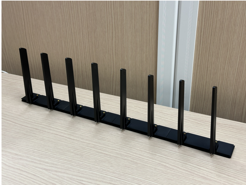
Figura 3.15: Soporte y ensamblado del array de monopolos.
