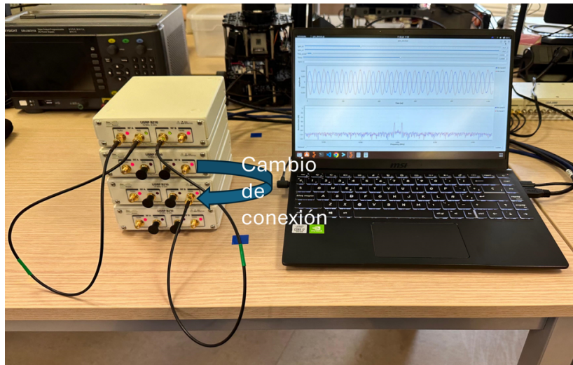
Figura 4.4: Cambio de la conexión para la sincronización del dispositivo 3.
