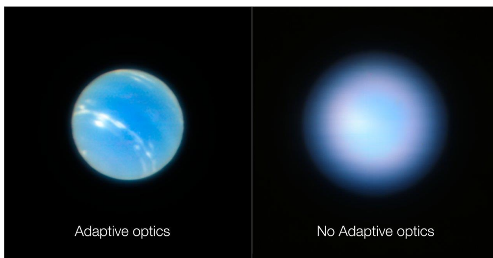
Figura 3.4- Imagen de Neptuno con y sin óptica Adaptativa captadas desde el Very Large Telescope (VLT) de ESO.
