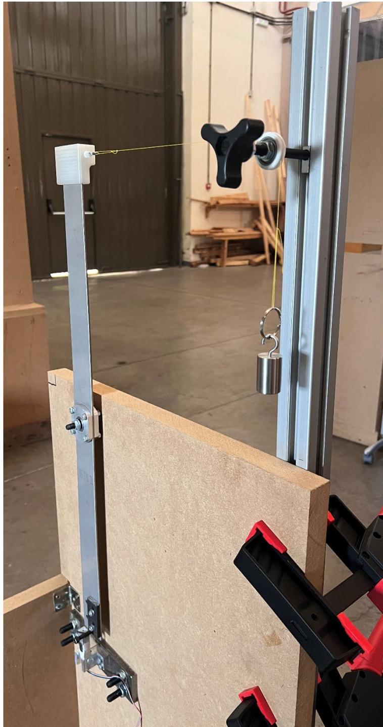
*Figura 33. Calibración con el peso de 100 g*
