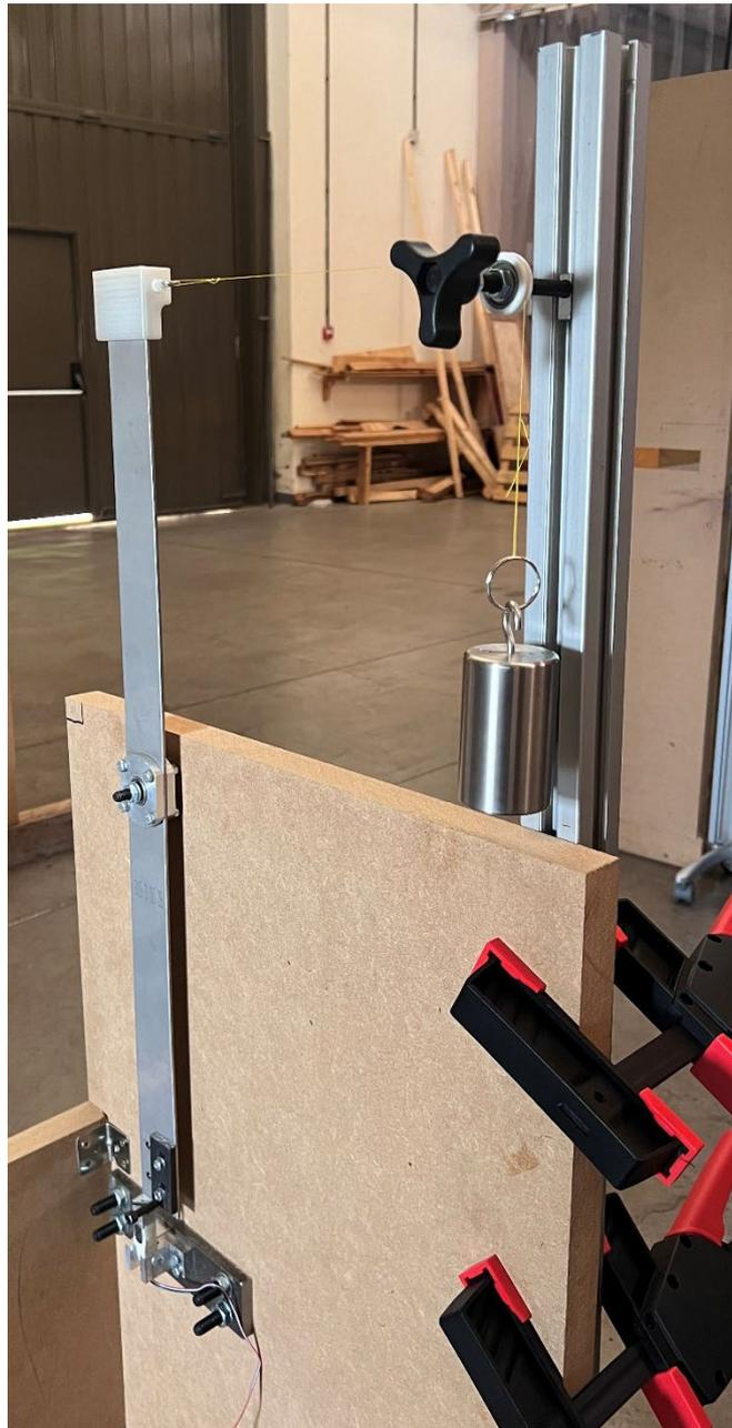
*Figura 34. Calibración de la balanza con el peso de 1000 g*
