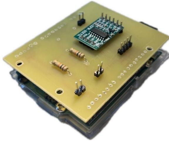
*Figura 29. Placa de circuito impreso conectada a la placa Arduino*
