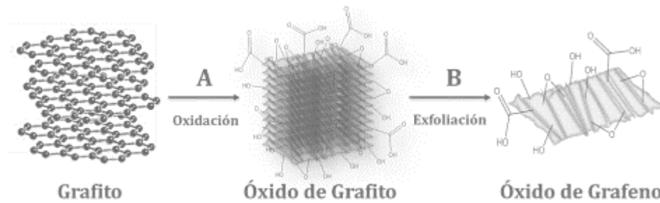
Fig. 3.3 Etapas de síntesis del GO a partir del grafito
