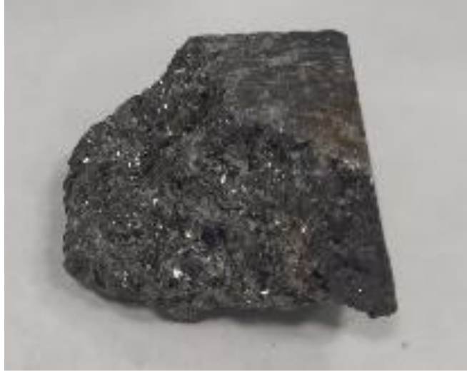
Fig. 4.1. Imagen de la roca de grafito utilizada como material de partida
