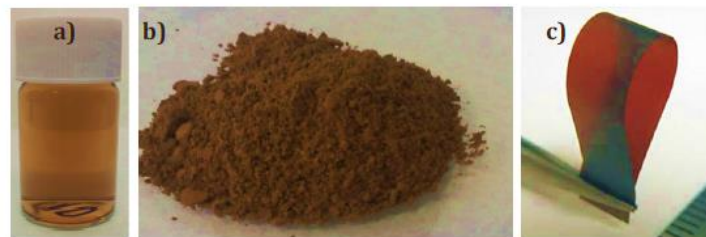
Fig. 3.4 a) Suspensión acuosa, b) Polvo de GO y c) Película de GO
