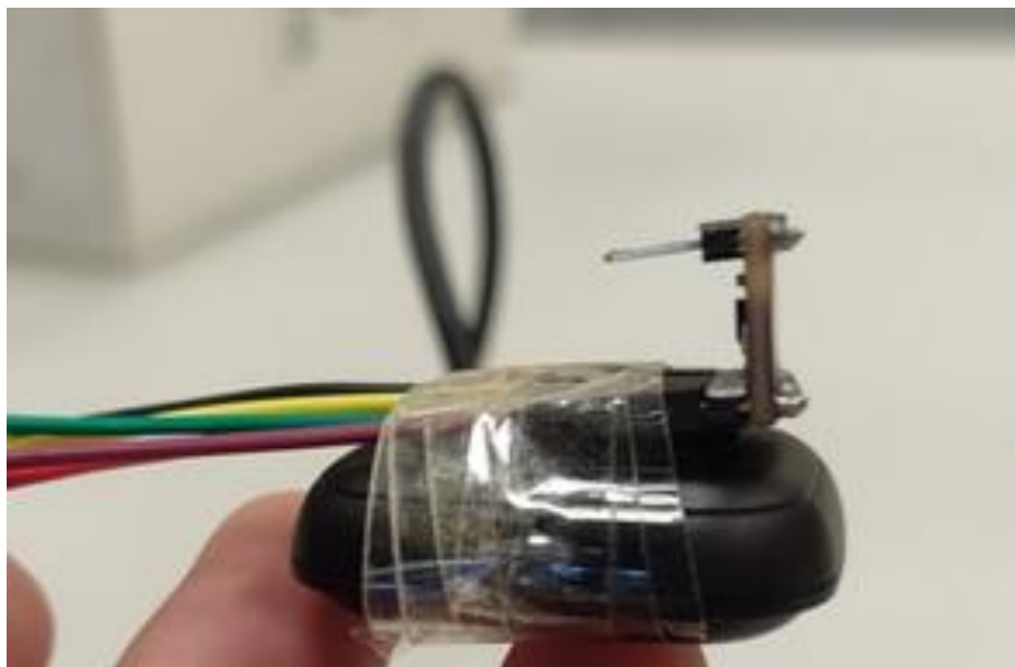
Figura 5.11.- Disposición de los sensores para el experimento, unidos mediante cinta adhesiva para simular que solo existe uno.
