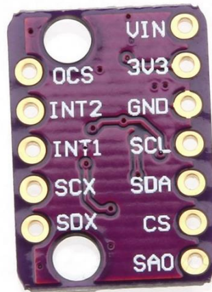
Figura 4.1.- Pines y forma de la IMU utilizada
