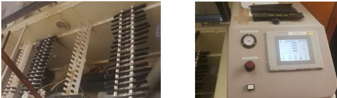
Figura 3.4. Cámara de niebla salina. a) Vista general probetas; b) Cuadro de mando
