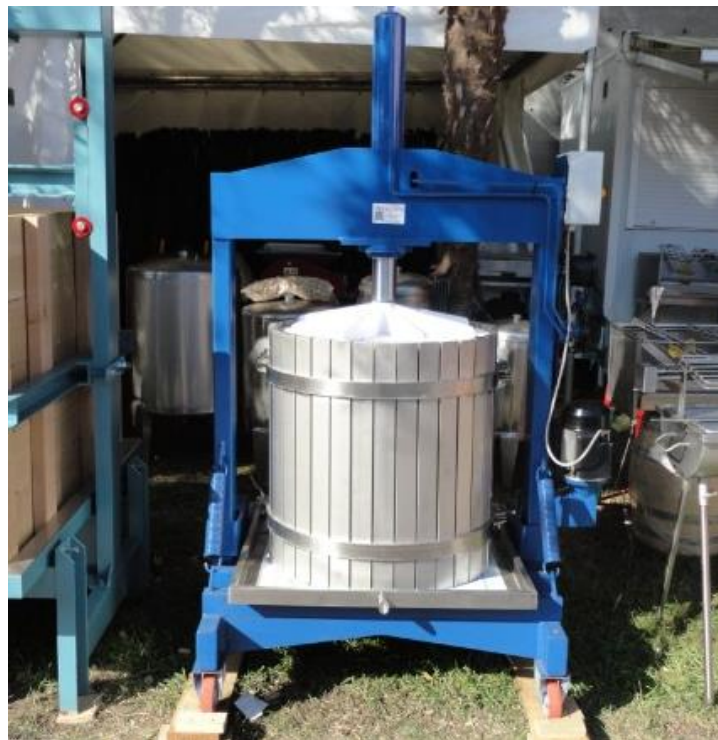
Figura 17. Lagar moderno de acero inoxidable.[32]
