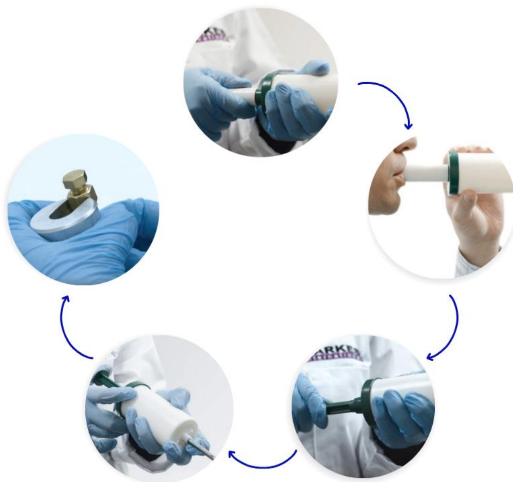
Figura 9. Etapas del proceso de muestreo de aire exhalado empleando un BioVOC-2. Imagen adaptada.
