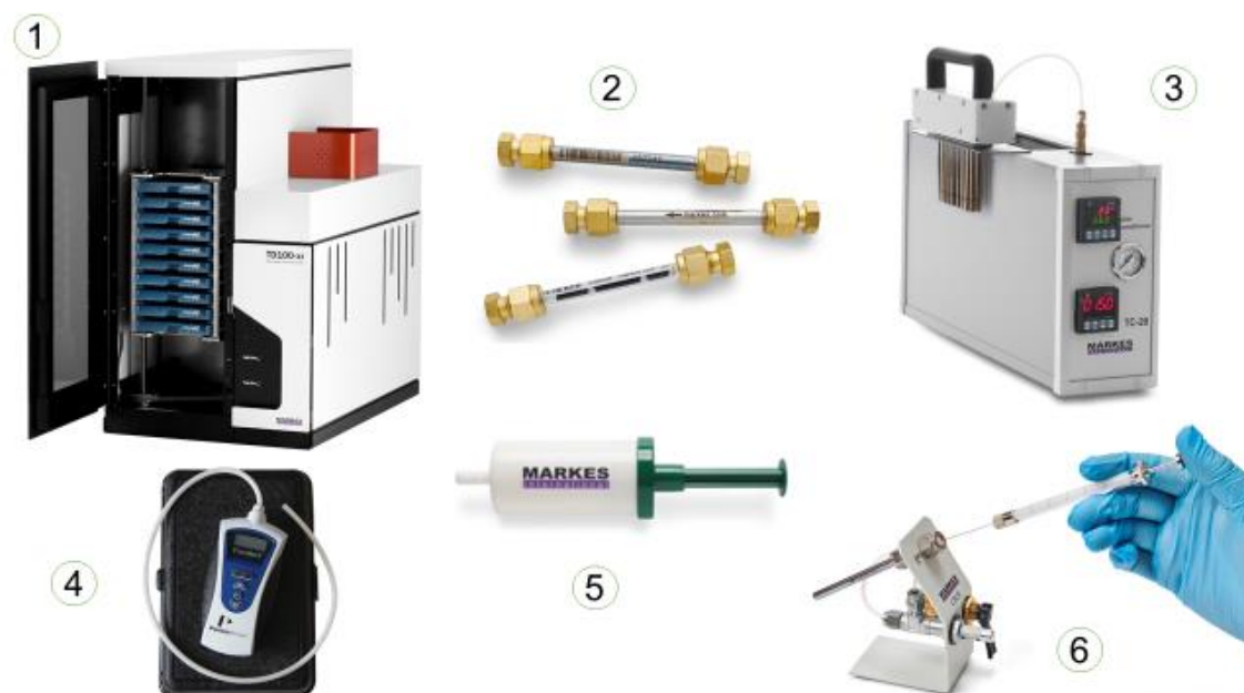
Figura 6. Instrumentación empleada de la casa comercial Markes International, Hamilton® y Perkin Elmer. ① se corresponde con el sistema de desorción térmica; ② son los tubos adsorbentes, sellados con tapones especiales de latón; ③ es el acondicionador de los tubos adsorbentes; ④ es el flujómetro, encargado de obtener el valor del flujo de nitrógeno a través del sistema CSLR; ⑤ es el sistema de recolección de aire exhalado, BioVOC-2; y ⑥ es el CSRL junto con la jeringa de precisión Hamilton, dispuesto para cargar un tubo adsorbente con un posible estándar.
