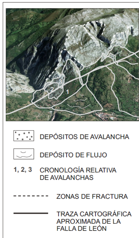
Fig. 2. Depósitos de ladera y principales zonas de desprendimiento rocoso en el margen NE de la Sierra de la Sobia. Sobre la ladera se ha marcado el trazo cartográfico aproximado de la Falla de León.
