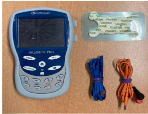
Figura 9. Sistema de electroterapia Vital-Stim, electrodos y cables.
