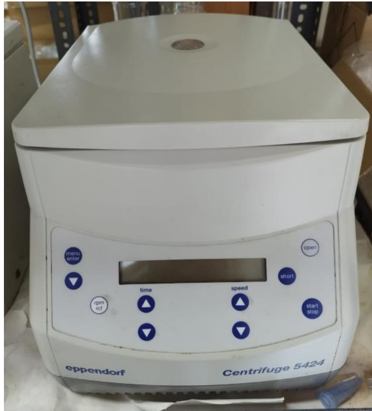
Figura 5. Centrifuga para eppendorf Centrifuge 5424
