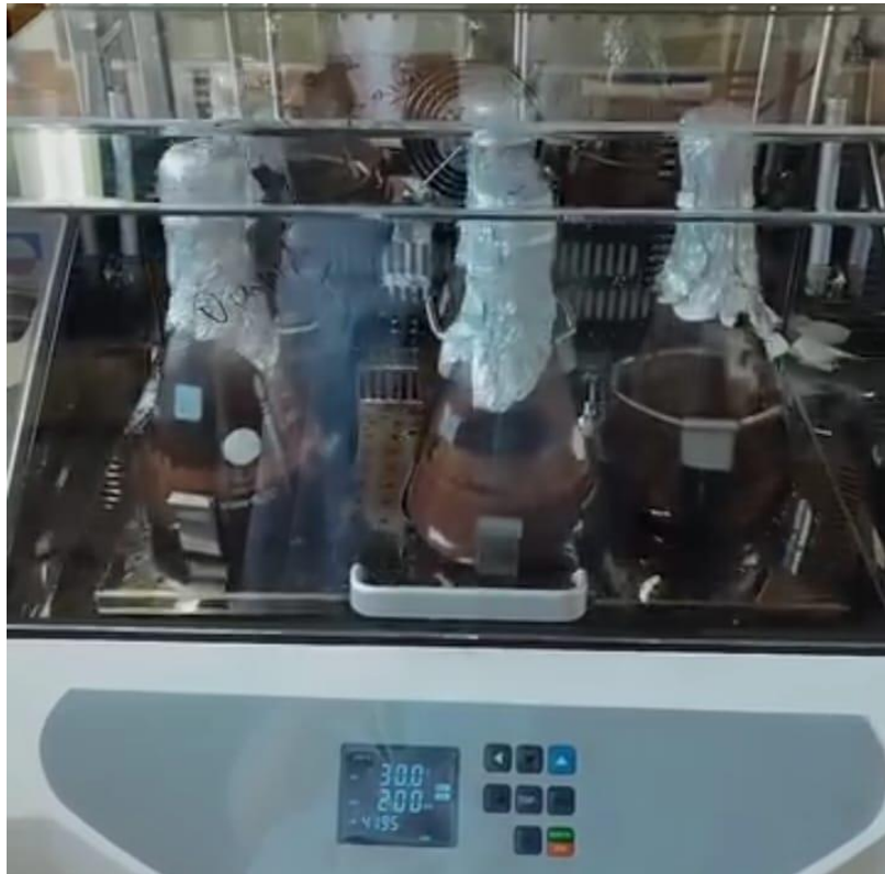
Figura 6. Incubador refrigerado con agitación orbital ECOLAN 70-R
