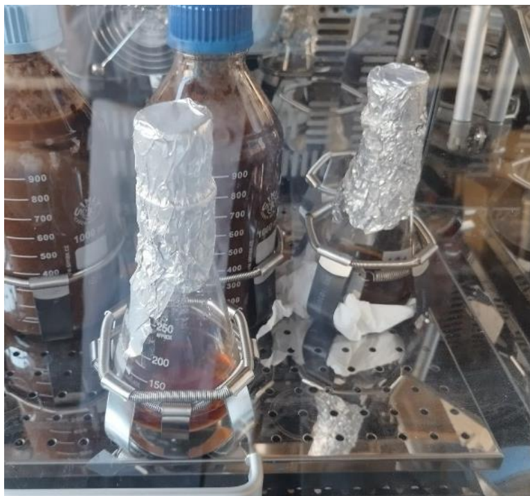
Figura 4. Matraces en la incubadora a 30°C y movimiento constante de 135rpm
