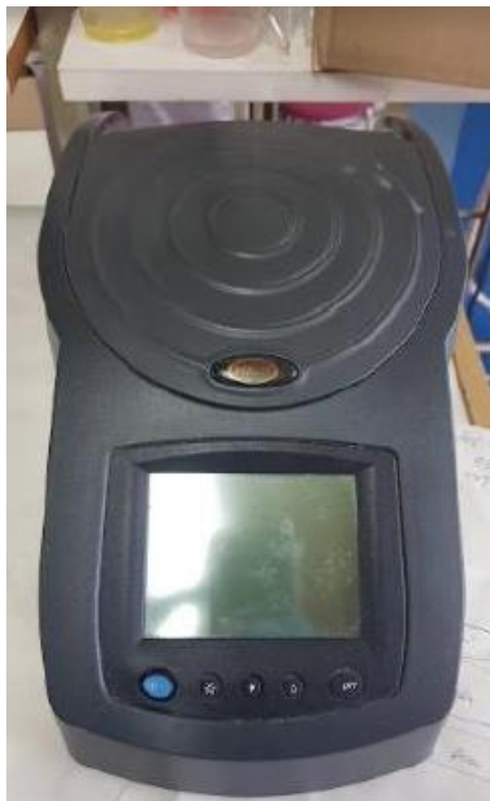
Figura 8. Espectrofotómetro Analytik Jena SPEKOL 1300/1500
