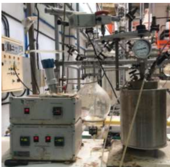
Figura 5. Reactor discontinuo modelo PARR T316SS ( Parr Instrument Co Moline ) con el que se llevaron a cabo los tratamientos hidrotérmicos.
