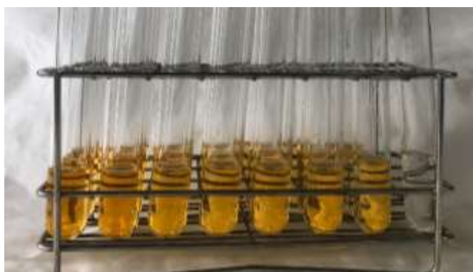
Figura 11. Muestras tras la adición de reactivos para la determinación de carbohidratos.
