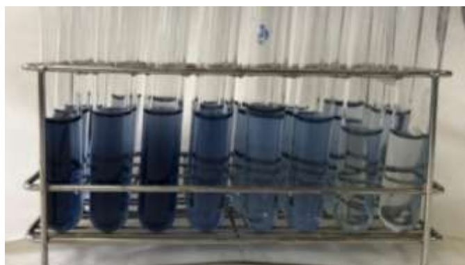
Figura 12. Muestras tras la adición de reactivos para la determinación de proteínas y ácidos húmicos.
