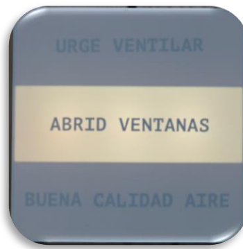
Figura 1.7.- Sensor de CO 2 decretando que urge abrir ventanas
