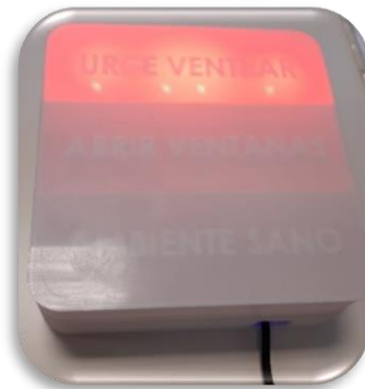
Figura 1.6.- Sensor CO 2 decretando que urge ventilar
