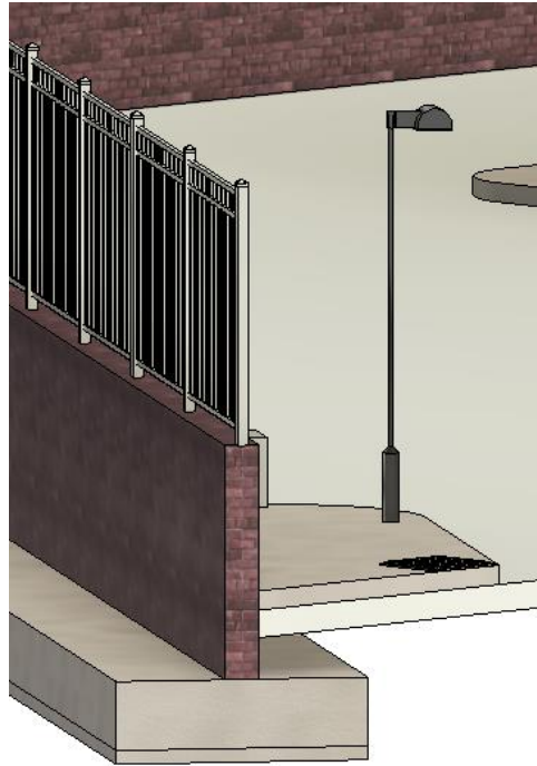
Ilustración 6.24. Imagen de muro, zapata e isleta a la salida de la unidad de suministro.
