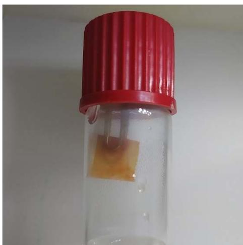
*Imagen 1 Análisis de patrón de 100 mg L<sup>-1</sup> de S<sub>2</sub>O<sub>5</sub><sup>2-</sup> en baño de agua a 75°C. En la imagen se observa la condensación del vapor de agua en el vial y la formación de manchas irregulares en el papel de extracción.*
