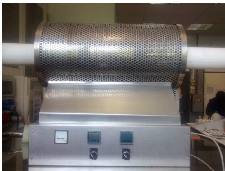
Figura 3.3.- Horno tubular empleado para la etapa de reducción térmica del GO
