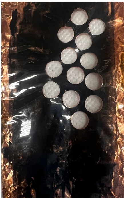
Figura 3.8.- Film de TRGO700 obtenido por Tape Casting con los electrodos recortados
