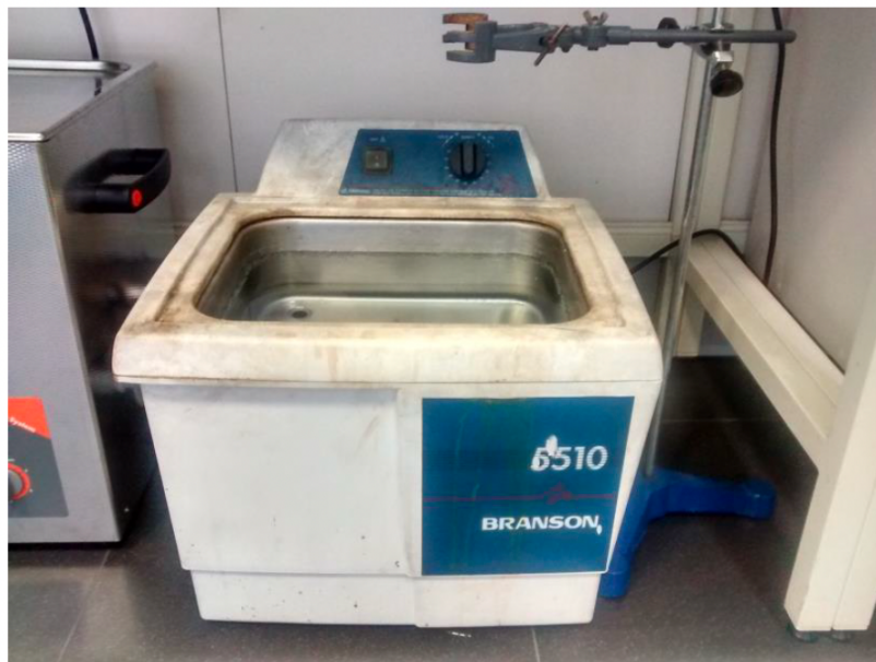
Figura 3.2.- Brasonic Ultrasonic Cleaner 5510E-MTH
