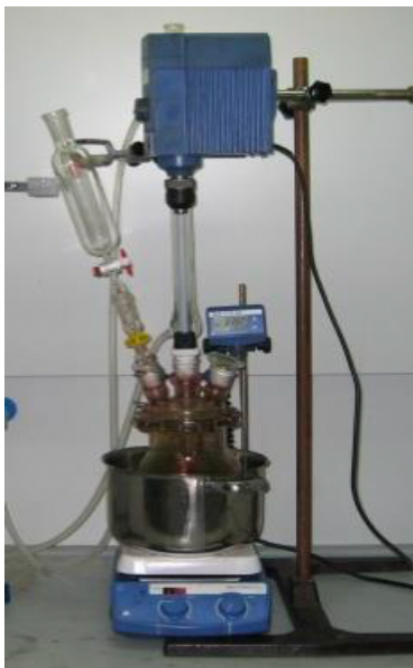
Figura 3.1.- Matraz de tres bocas donde se realiza el método Hummers
