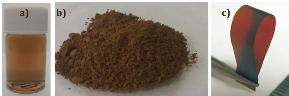
Figura 1.7.- a) Suspensión acuosa de GO; b) GO en polvo y c) película de GO
