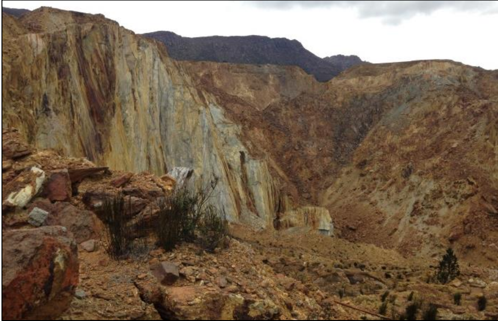
Figura 5.11. Generación de cráter de subsidencia, con presencia de planos de desplome que definen el ángulo de quiebre, debido a una explotación de caving en Australia (Fernández, 2018).
