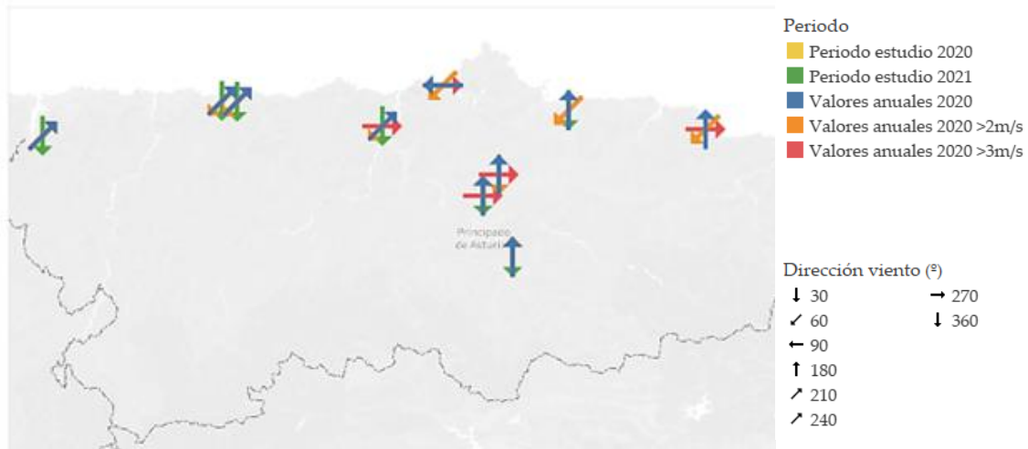
Figura 16: Direcciones predominantes del viento en diferentes lugares y periodos de muestreo.
